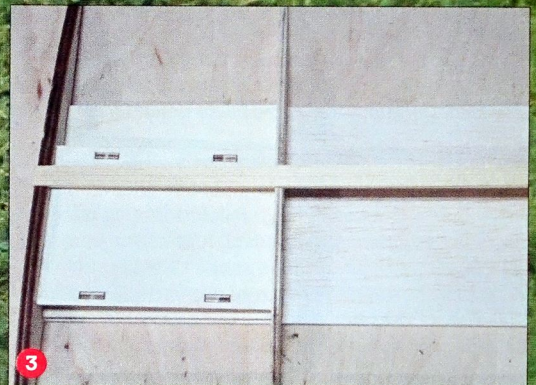
Die Sperrholzspanten sind zur Verstärkung teilweise aufgedoppelt (1). Der Rumpf besteht aus mehreren Segmenten, die miteinander verzapft werden (2). Zwei Sperrholzteile bilden eine Tasche für die Flächensteckung (3)
