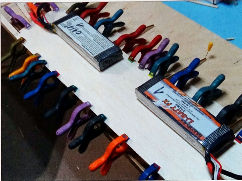
Zwei kurze Drahtstücke markieren auf der Flächenunterseite fühlbar den Schwerpunkt nach Plan
