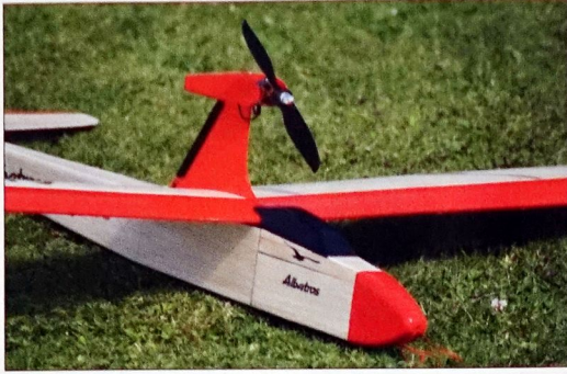
Der Motoraufsatz gehört zum Lieferumfang und macht den Albatros zum Elektrosegler
