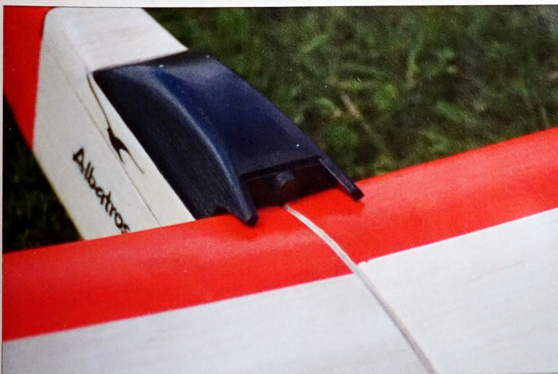
Ein Holzstift im Hauptspant sichert die Kabinenhaube
