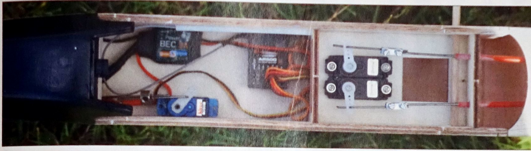
Reichlich Platz für Empfänger, BEC und das Kupplungsservo vorne und die beiden Leitwerksservos dahinter
