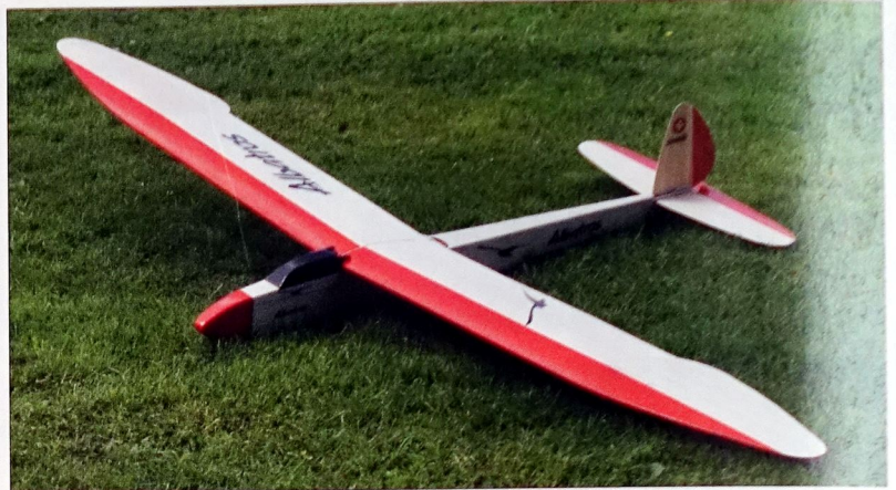
Durch den Tiefsprung am Außenflügel erhält der Albatros eine klassische Optik
